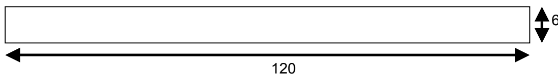
Figure II.19 : Eprouvette pour essais isothermes en solidification
