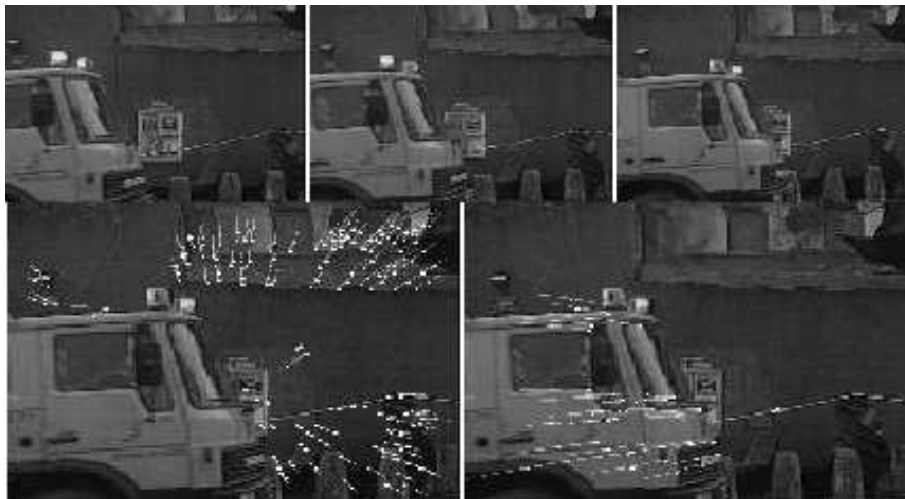
FIG. 2.3 – Segmentation du mouvement utilisant la méthode de P. Torr [Tor95], dans cette séquence la caméra et le camion bougent, ce qui permet d'extraire deux mouvements apparents : le fond et le camion et donc de détecter les obstacles mobiles.
