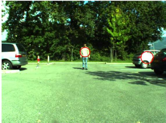
(a) Image de test et échelle caractéristique prise en 3 points particuliers (centre du piéton, poteau de gauche et voiture à droite). Les positions des trois points et de l'échelle caractéristique correspondante sont représentées par trois cercles rouges.
