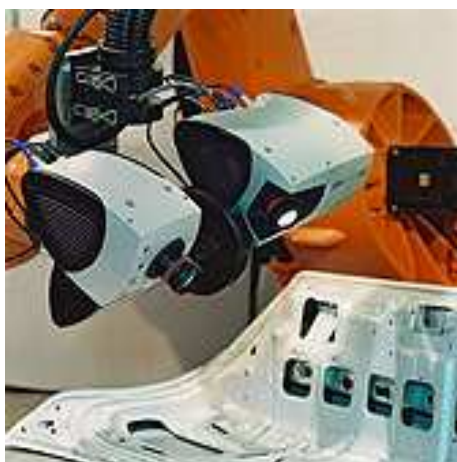
Figure 4.49 – Scanner CometV sur bras robotisé
