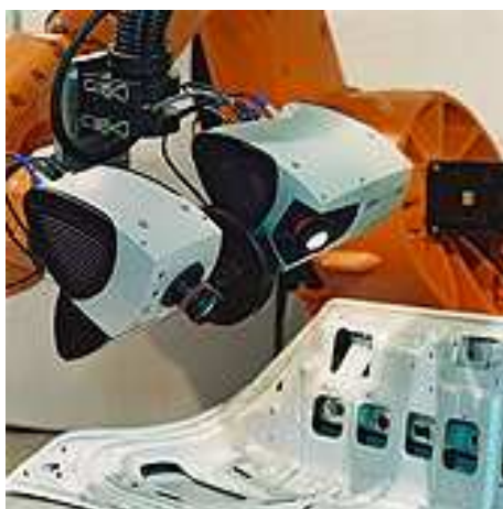
Figure 4.49 – Scanner CometV sur bras robotisé
