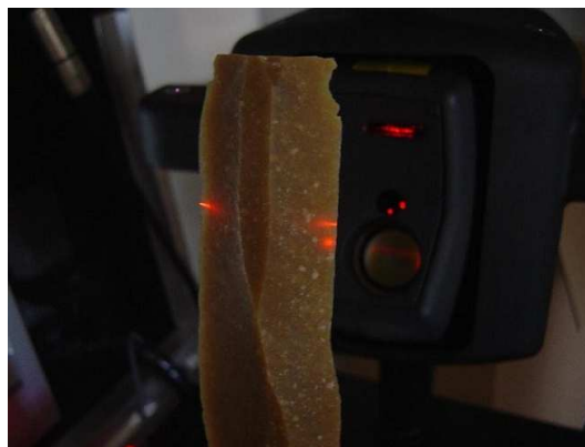
Figure 3.7 – Problème de matériau : bords translucides
