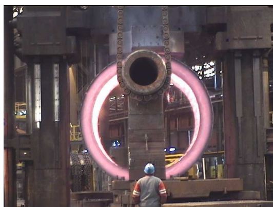
Figure 2.19 – Numérisation d'une pièce de forge à haute température [Bokhabrine et al., 2009] rieuse à vingt millimètres.
