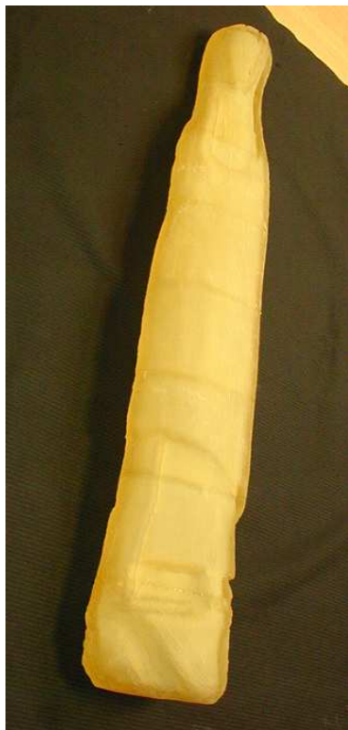
Figure 3.16 – Modèle 3D en résine, duplication par impression 3D
