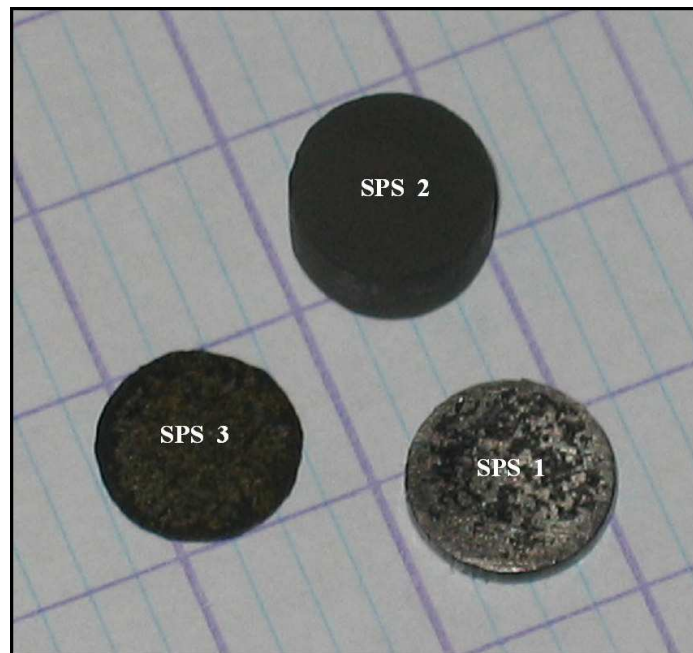
Fig. 4.32 – Pastilles de métal \text{FeNi} (SPS 1), de nanocomposite \text{FeNi}@\text{SiO}_2 (SPS 2) et de nanocomposite \text{FeNi-NiZnCu} (SPS 3), obtenues par « Spark Plasma Sintering » (SPS).
