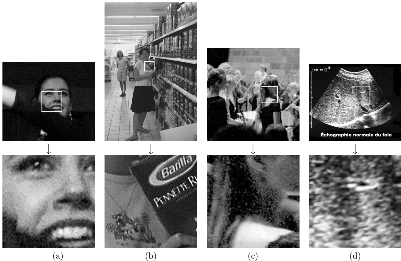
FIG. 1 – Bruit naturel dans des images numériques. (a) bruit de sensibilité pour un appareil photo numérique. (b) bruit de scan. (c) bruit de sensibilité + scan. (d) échographie.
