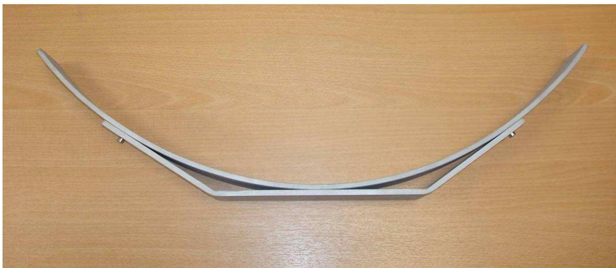
Figure 3-26 : Vue de profil de la tôle cintrée avec renforts
