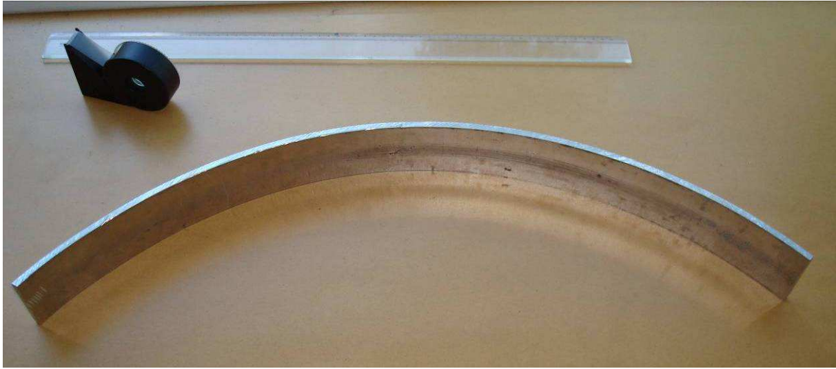
Figure 3-25 : Vue de profil de la tôle cintrée qui servira de branche pour le faux miroir
