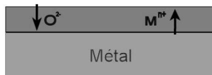
Figure I.18: Modes de croissance de la couche d'oxyde
