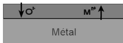
Figure I.18: Modes de croissance de la couche d'oxyde
