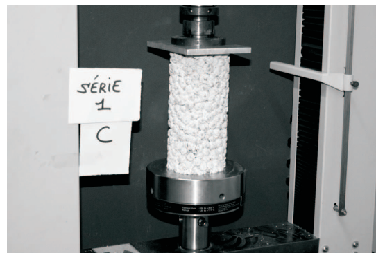
FIG. 5.2 – Echantillon expérimental de forme cylindrique soumis à un essai de compression simple.
