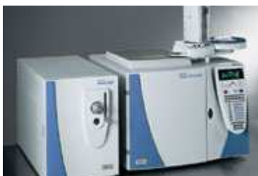
Figure 2.15 : Chromatographe en phase gazeuse couplé à un spectromètre de masse à piégeage de charges (Finnigan PolarisQ)
