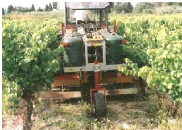
Figure 1.5 : Désherbage thermique de la vigne
