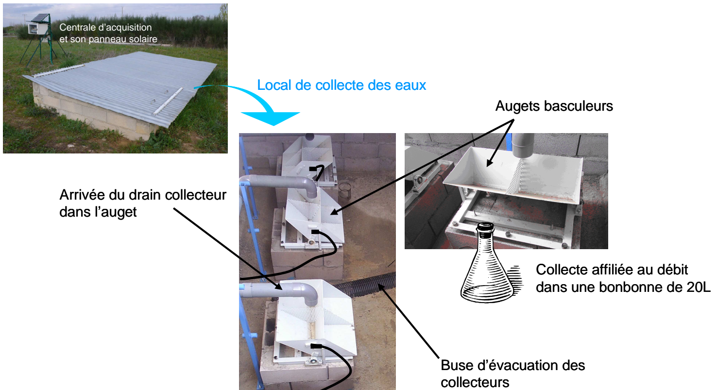
Figure 2.9 : Dispositif de prélèvement des eaux de drainage et de mesure des débits affiliés
