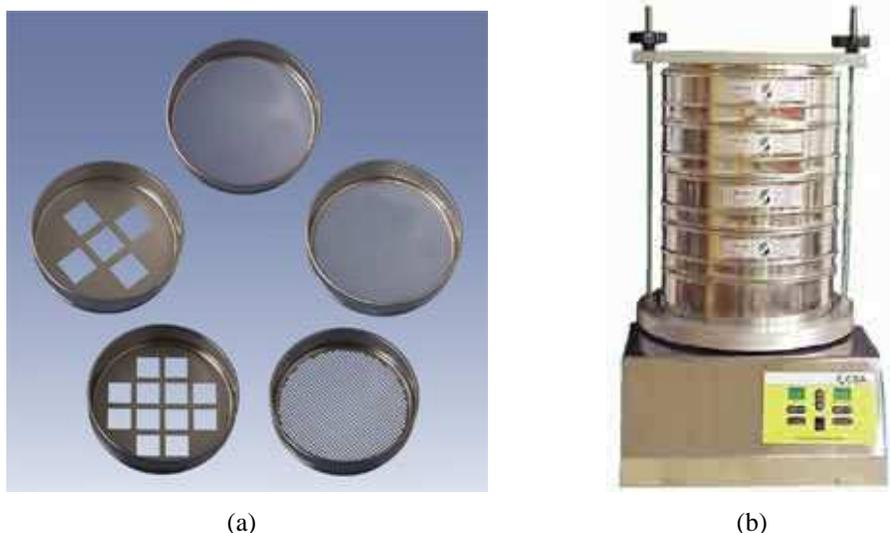
FIG. 1.7 – Tamis en tôle perforée et en maille métallique (a). Tamiseuse en ordre de fonctionnement (b).
