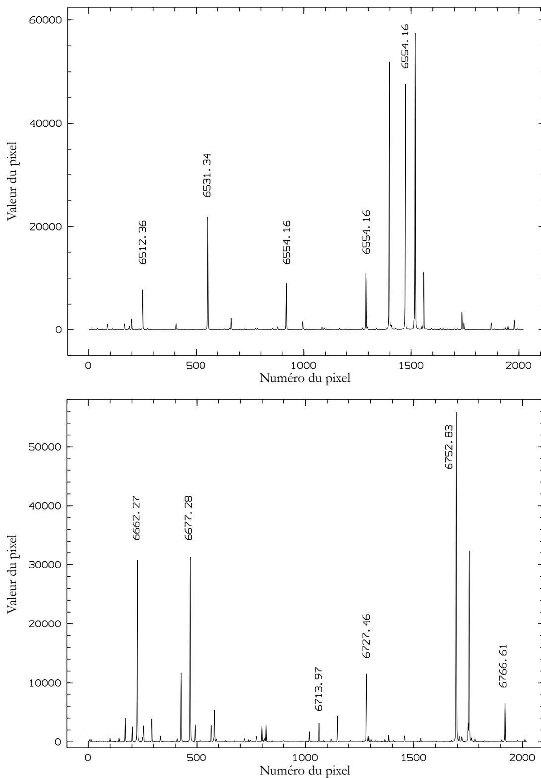
FIG. I.12 – Identification des raies utilisées lors de la calibration des spectres dans les régions spectrales centrées autour de la raie  $H\alpha$  (*en haut*) et de celle du lithium (*en bas*). Toutes les longueurs d'onde indiquées sur la figure s'expriment en Å.
