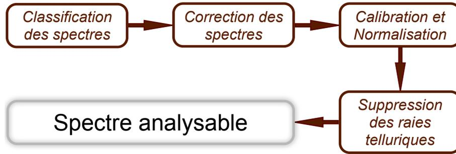
FIG. I.10 – Schéma illustrant les différentes étapes de la procédure de réduction d’une nuit d’observations. Elle est utilisée pour rendre les spectres exploitables lors d’une analyse détaillée.
