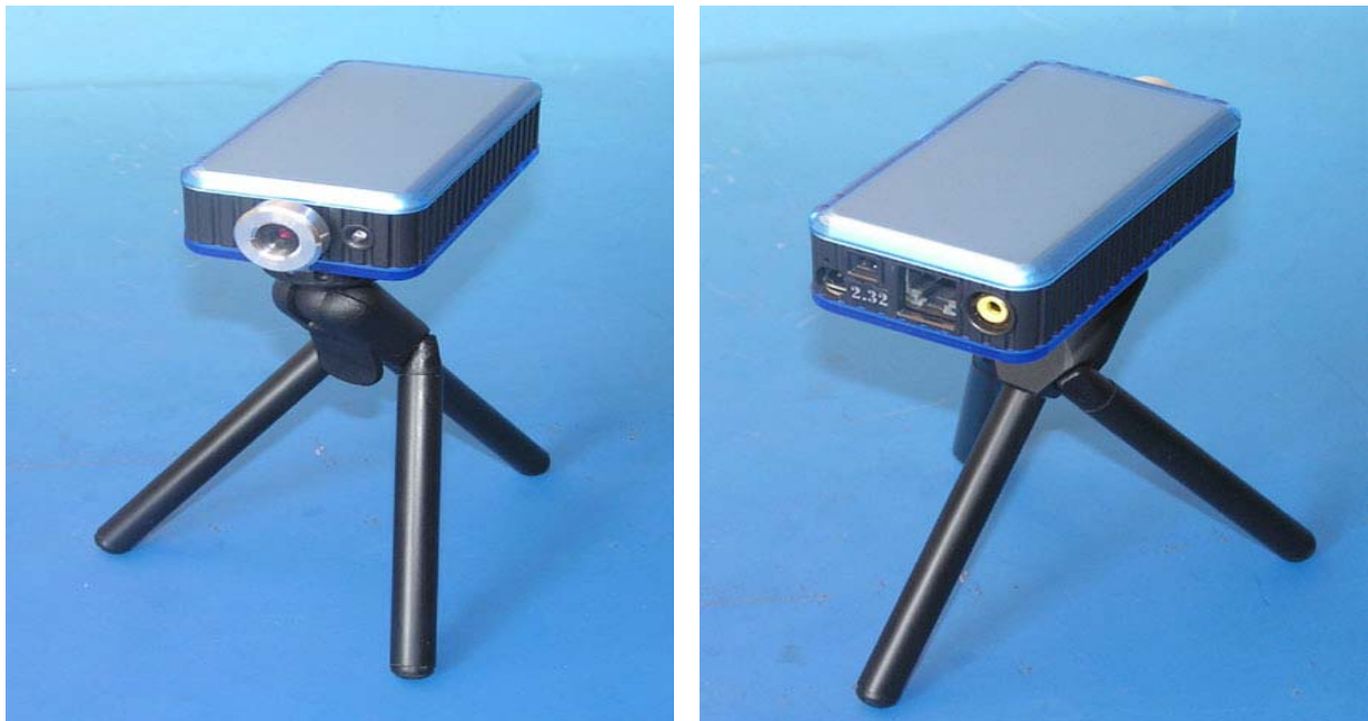
Figure.5 : Camera de surveillance sur réseau internet sans PC (JR international)
