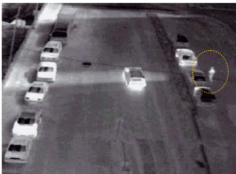
Figure.4 : Image de caméra infrarouge identifiant un piéton à droite de l'image (FLIR System).
