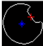
Figure.76 : Le contour de l'image de la pièce type avec la localisation de l'encoche à l'aide de la méthode de Freeman.
