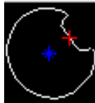
Figure.76 : Le contour de l'image de la pièce type avec la localisation de l'encoche à l'aide de la méthode de Freeman.
