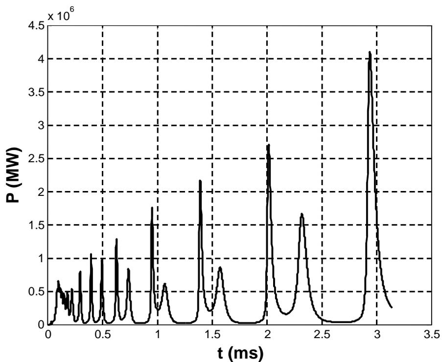
Figure 3.15.g : Puissance injectée dans l'intervalle d'air.
