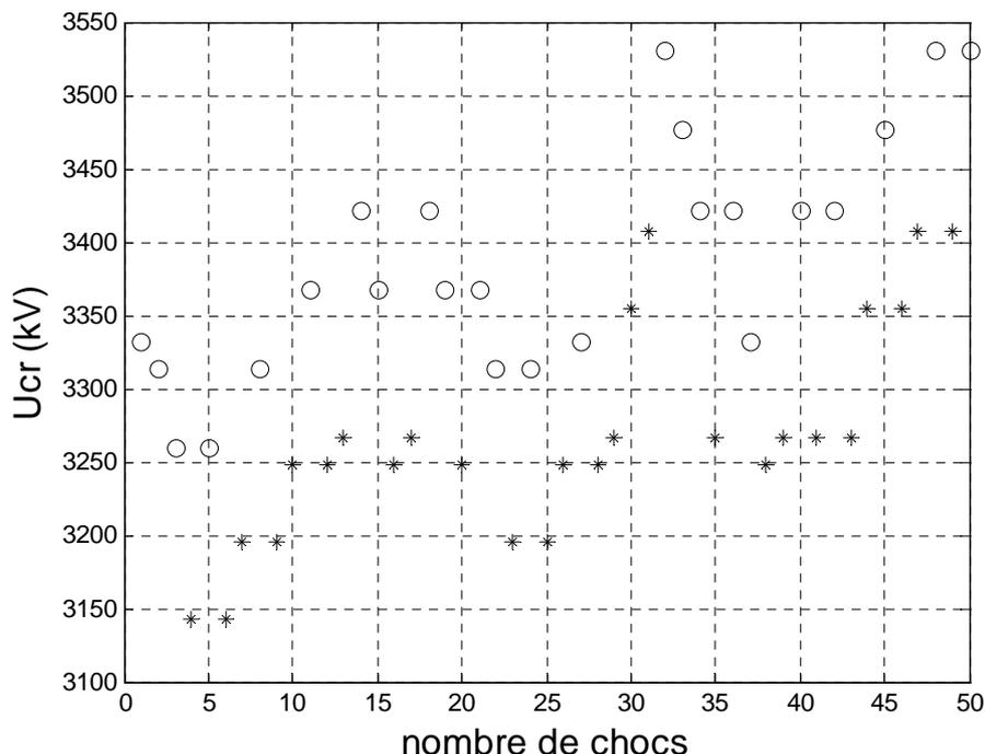
Figure 3.8: Une séquence "up and down". Intervalle  $D = 10$  m. Onde  $60/3000 \mu\text{s}$ . Les cas d'amorçage sont caractérisés par les points « o » et les cas de tenue par des astérix « \* ».  $U_{50} = 3325,7$  kV et  $\sigma = 4,2\%$ .
