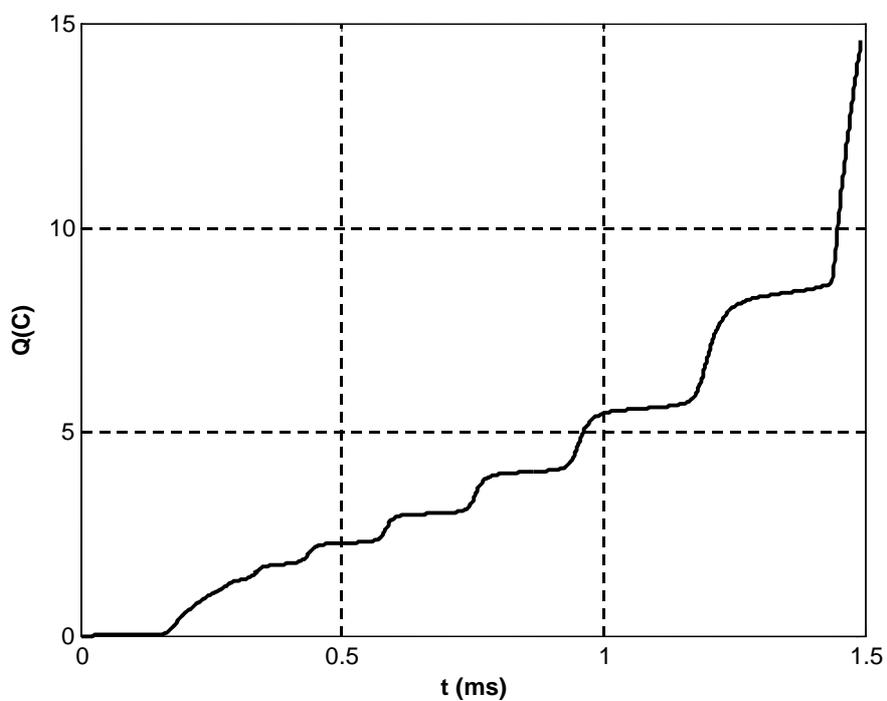
Figure 3.13.c : Charge injectée dans l'intervalle d'air.
