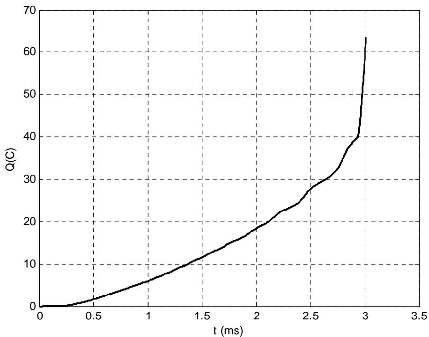
Figure 3.16.c : Charge injectée dans l'intervalle d'air.
