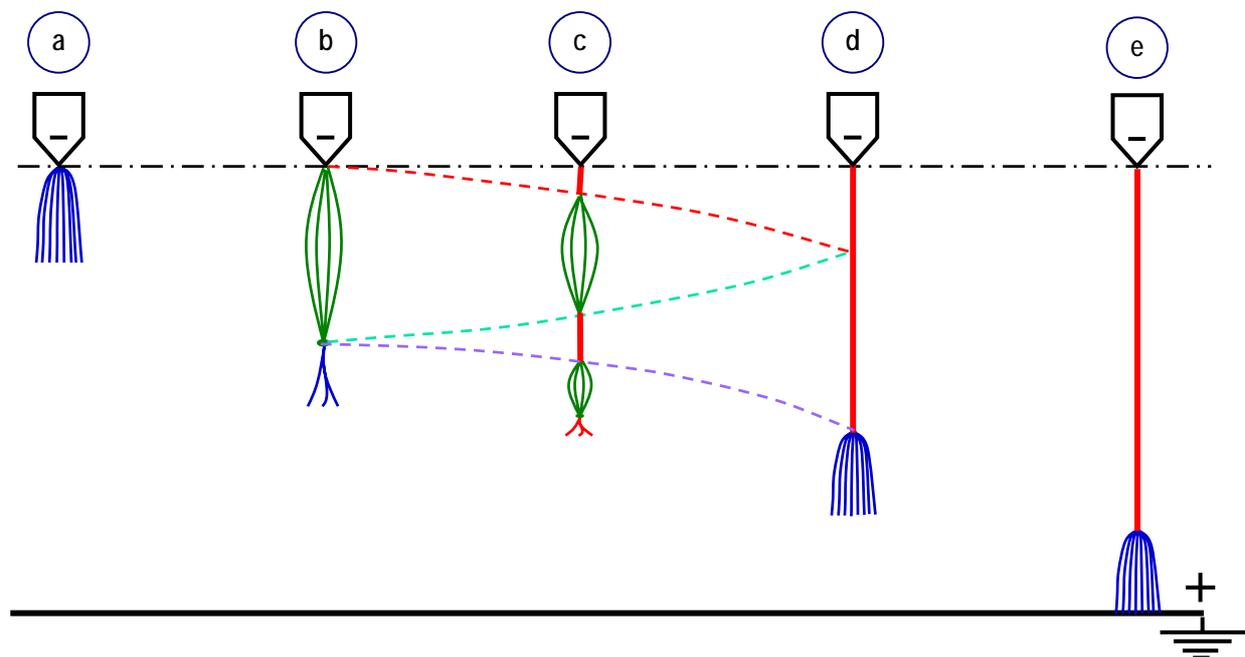
**Figure 1.9 : Schéma simplifié de la propagation de la décharge négative. (a) : Initiation de la première, (b) : apparition du système pilote, (c) : apparition des leaders spatiaux et du leader négatif à l'électrode, (d) : réillumination et (e) : saut final.**
