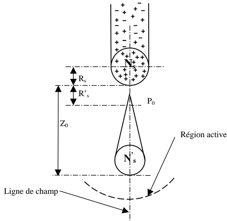
Figure 1.7 : Mécanisme de propagation et avalanche équivalente en polarité négative [6]
