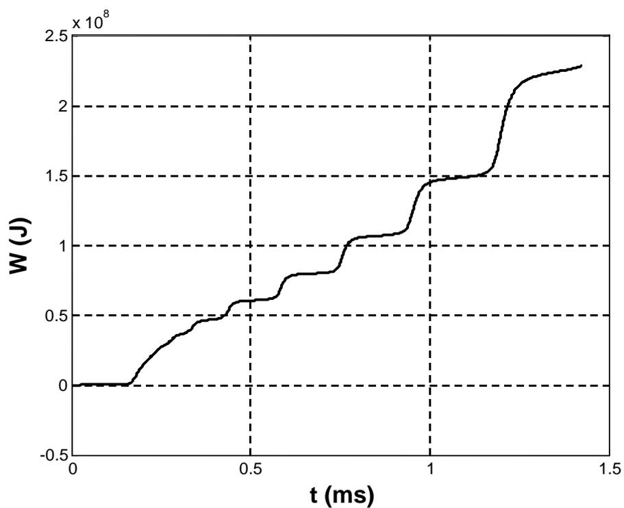
Figure 3.14.h : Energie injectée dans l'intervalle d'air.
