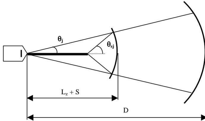
Figure 2.9 : Approximation sphérique utilisée pour le calcul des capacités [18]
