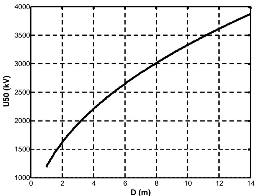
Figure 3.3: Evolution de la tension de claquage  $U_{50}$  en fonction de la distance interélectrode  $D$  pour une configuration d'électrodes pointe – plan (pointe hémisphérique de diamètre 0,6 m) soumis à des tensions de polarité négative pour une onde 60/3000  $\mu$ s d'après le groupe des Renardières [23].
