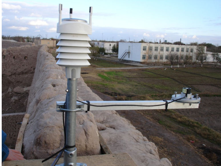
FIG. 5.5 – Photo du mât météorologique : la station météorologique au sommet du mât et le pyranomètre au bout de la barre horizontale.
