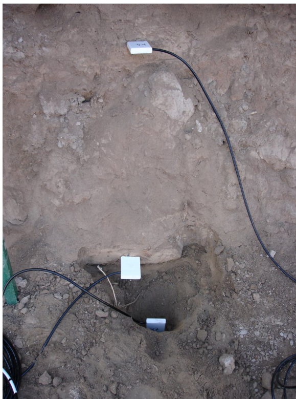
FIG. 5.21 – Trois des quatre sondes réfléchométriques équipant le sillon de dégradation. De haut en bas : N2.5H, N1.9H et N1.7V. La quatrième sonde (N3.9H) située au-dessus du sillon n'est pas visible sur la photo.
