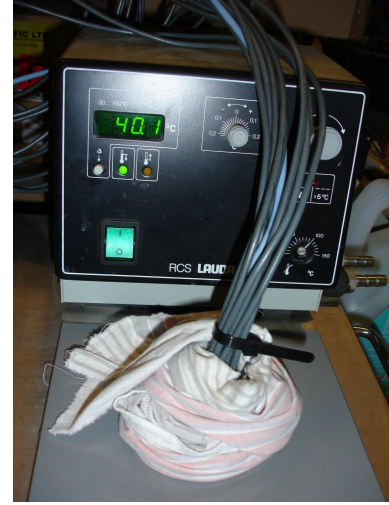
(b) Étalonnage des capteurs de température.
