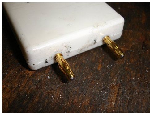
FIG. 5.22 – Photo d'une sonde d'humidité CS616 modifiée.
