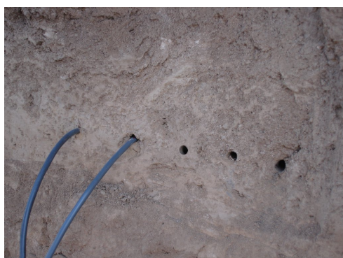
(c) Deux thermistances mises en place.
