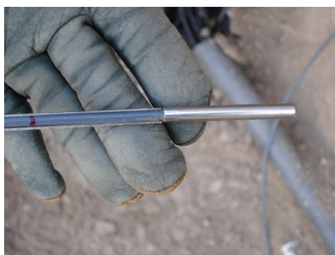
(a) Thermistance prête à être installée.
