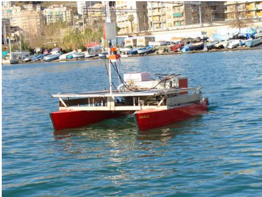
FIG. A.5 – L’USV du CNR : le catamaran Charlie dans le port de Gênes en phase de test
