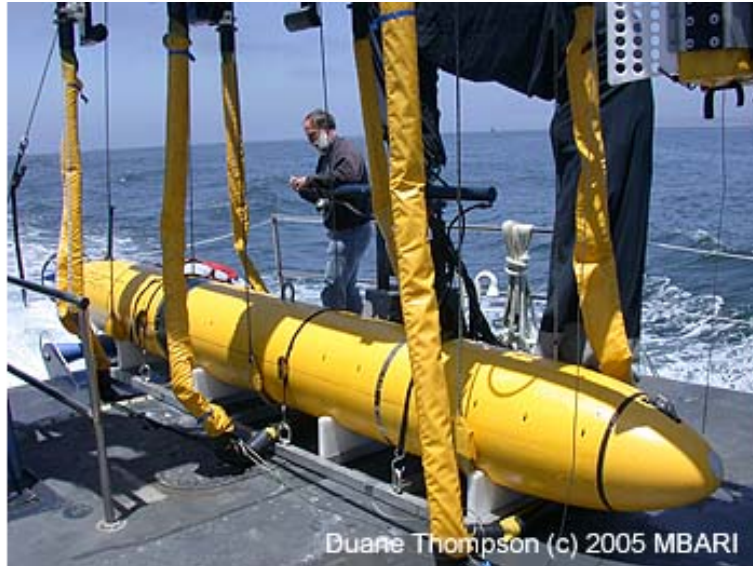
FIG. 2 – AUV utilisé au MBARI comportant 3 sonars.
