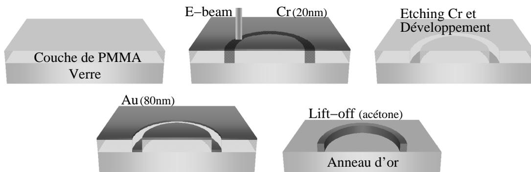
(a) Schéma du processus lithographie électronique avec une résine positive.
