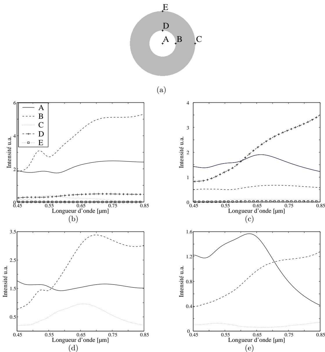
FIG. 3.12 – (a) Position des points d'analyse **A** à **E** par rapport à la géométrie de l'anneau. Courbes spectrales  $S$  pour le champ électrique en (b,d), pour le champ magnétique en (c,e). pour la polarisation linéaire suivant la direction (AC), polarisation circulaire en (d,e).
