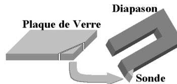
FIG. 1.3 – Schéma de fabrication d'une "pointe tétraédrique" [11, 12].
