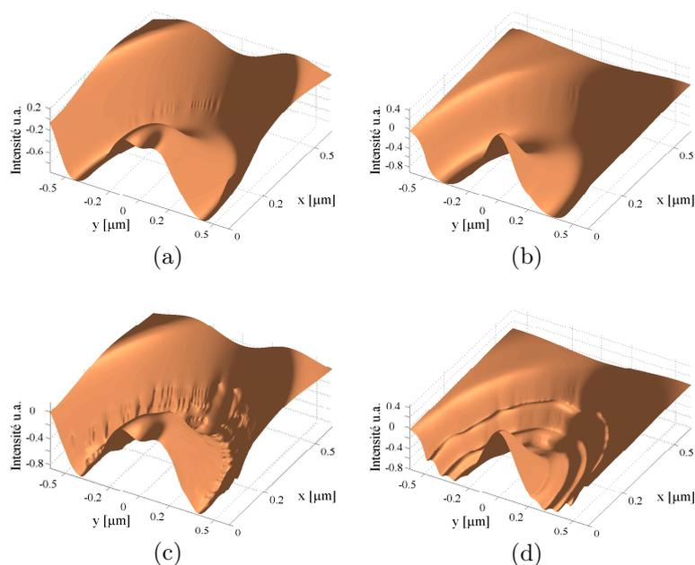
FIG. 3.22 – Variation de l'intensité du champ  $F$  pour la polarisation azimutale. (a,b) champ électrique et magnétique pour l'anneau entier respectivement, (c,d) champ électrique et magnétique pour l'anneau évidé azimutalement.
