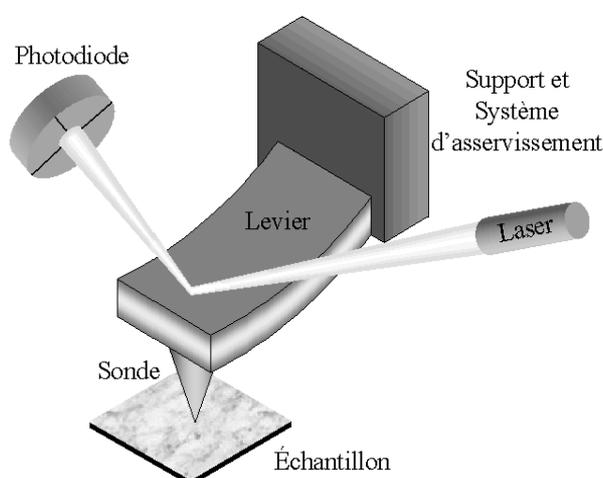
FIG. 1.8 – Schéma de fonctionnement des sondes de type *AFM*. Le faisceau laser et la photodiode permettent de contrôler la déflexion du levier.
