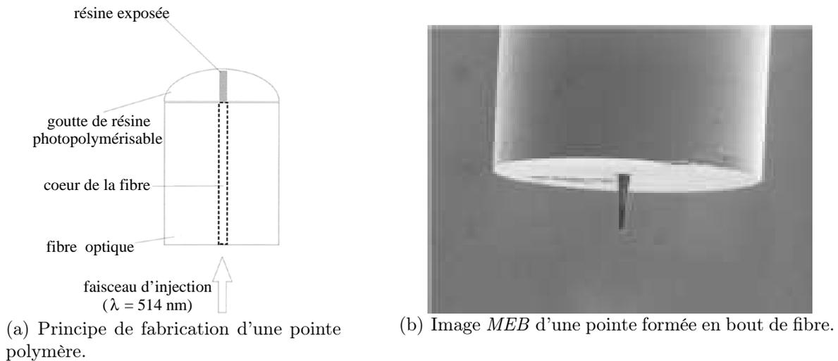
FIG. 1.7 – Fabrication d'une pointe polymère d'après la référence [31].
