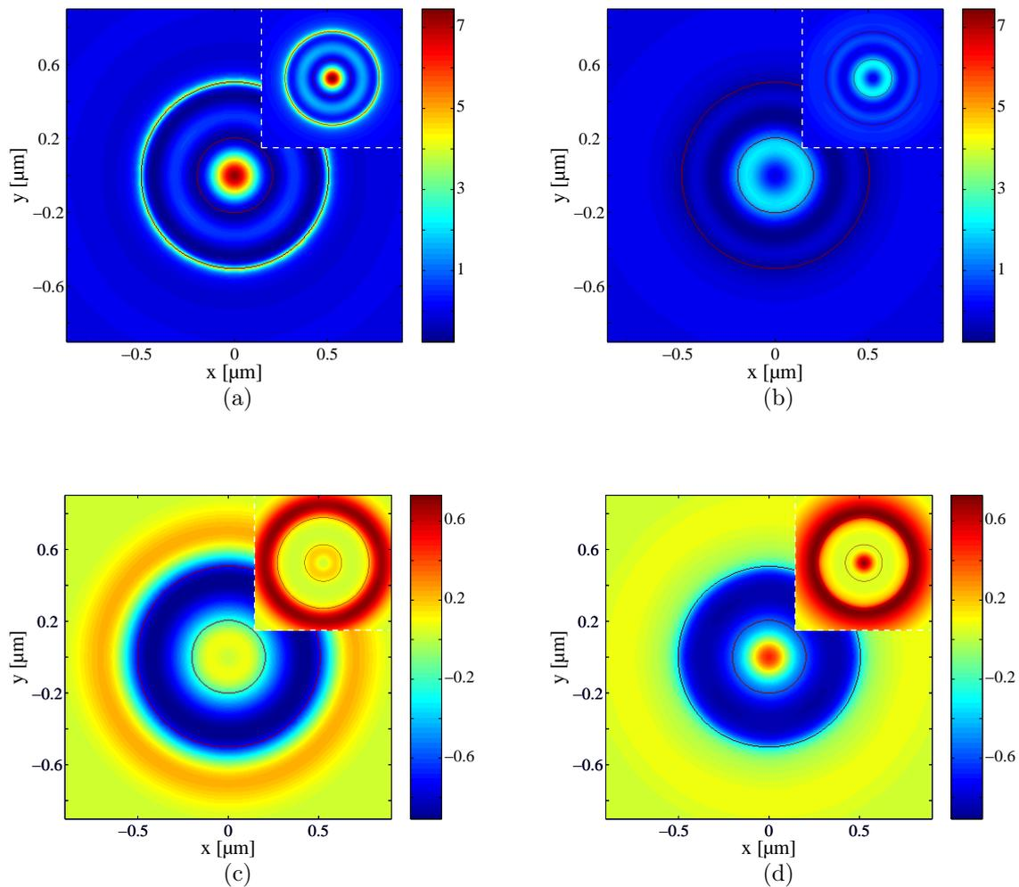
FIG. 3.15 – Variations d'intensité ( $F(x, y, z_0, \omega_0)$ ) du champ électrique ( $a, c$ ) et du champ magnétique ( $b, d$ ) pour les polarisations radiale ( $a, b$ ) où  $\lambda_0 = 514 \text{ nm}$ , et azimuthale ( $c, d$ ) où  $\lambda_0 = 514 \text{ nm}$ . Dans le coin supérieur droit, l'intensité du champ simulé avec l'anneau ( $G_a$ ) sur le plan d'analyse  $z_0$ . Les 2 lignes noires représentent les bords de l'anneau.
