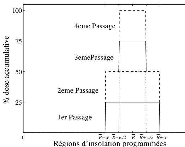
FIG. 4.8 – Caractéristiques des zones programmées pour l'application de la dose de chaque passage par rapport au centre de la couronne circulaire.  $\bar{R}$  est le rayon moyen et  $w$  est la demi largeur de la couronne insolée.
