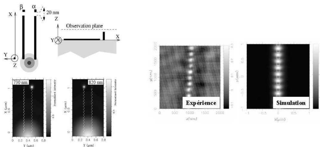
(a) Exemple de deux rubans métalliques utilisés comme guide d'ondes pour exalter deux particules carrées,  $\beta = 20 \times 30 \text{ nm}^2$   $\alpha = 30 \times 30 \text{ nm}^2$ . Extrait des travaux présentés par Weeber & *al.* [104].
