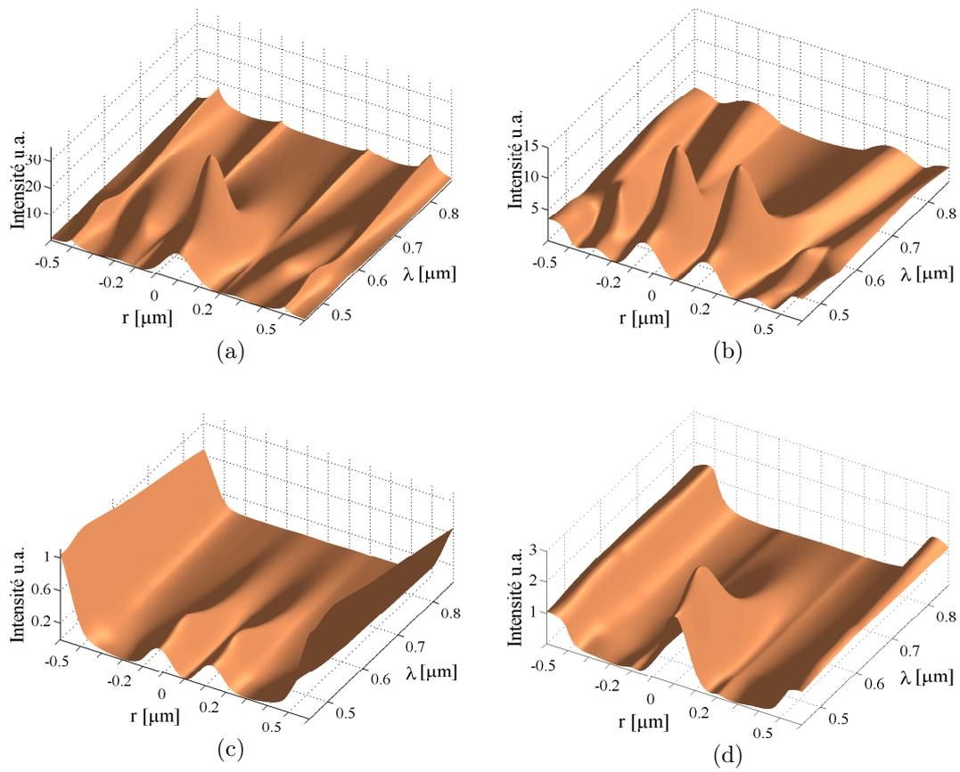
FIG. 3.11 – Spectre normalisé  $S$  pour la polarisation radiale et azimutale (en  $a,b$  et  $c,d$  respectivement) du champ électrique ( $a,c$ ) et du champ magnétique ( $b,d$ ) pour la ligne  $y = 0$ .
