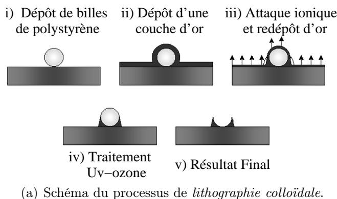
(a) Schéma du processus de *lithographie colloïdale*.
