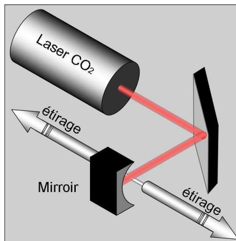
FIG. 1.5 – Schéma de principe du chauffage-étirage
