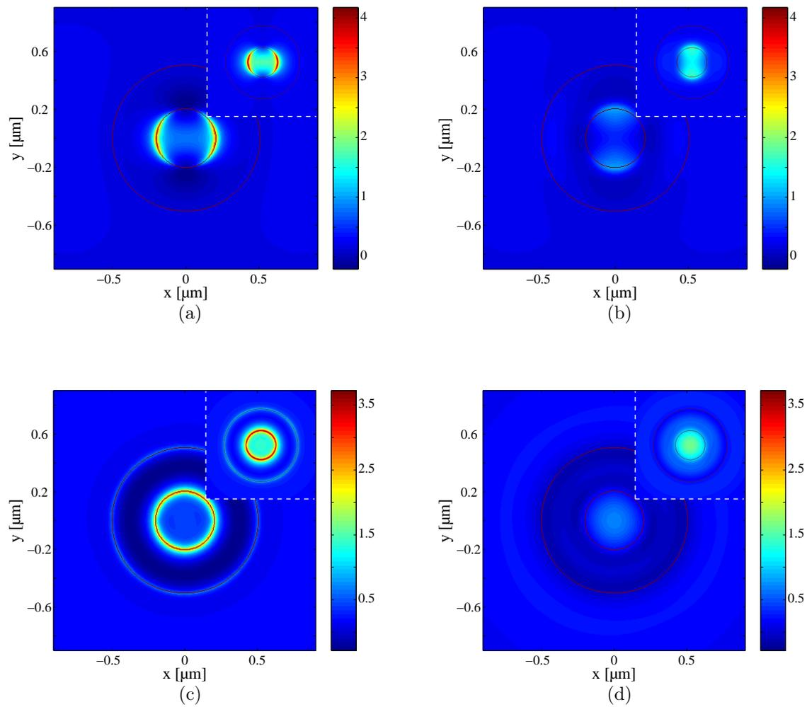
FIG. 3.14 – Variations d'intensité ( $F(x, y, z_0, \omega_0)$ ) du champ électrique ( $a, c$ ) et du champ magnétique ( $b, d$ ) pour les polarisations, linéaire ( $a, b$ ) et circulaire ( $c, d$ ),  $\lambda_0 = 752 \text{ nm}$ . Dans le coin supérieur droit, l'intensité du champ simulé avec l'anneau ( $G_a$ ) sur le plan d'analyse  $z_0$ . Les 2 cercles noirs représentent les bords de l'anneau,  $500 \text{ nm}$  de rayon extérieur et  $200 \text{ nm}$  de rayon intérieur).
