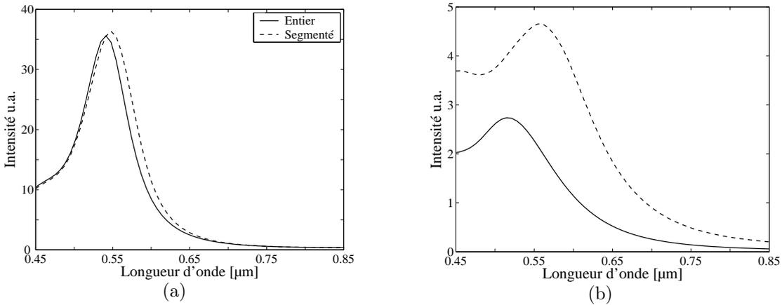
FIG. 3.28 – Courbe spectrales  $S$  au centre de l'anneau sur le plan d'analyse ( $z = z_0$ ), pour l'anneau segmenté sur la paroi interne représenté sur la figure 3.27. (a) pour le champ électrique en polarisation radiale, (b) pour le champ magnétique en polarisation azimutale.
