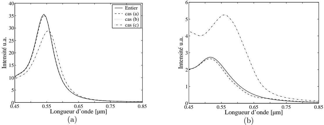
FIG. 3.24 – Courbes spectrales  $S$  au centre de l’anneau dans le plan d’analyse ( $z = z_0$ ), pour un anneau segmenté sur les parois interne et externe. (a) pour le champ électrique en polarisation radiale, (b) pour le champ magnétique en polarisation azimutale.
