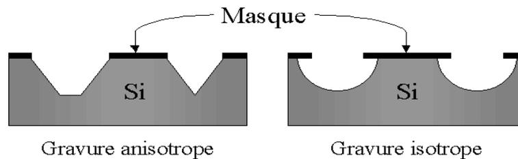
FIG. 1.9 – Résultats de gravure anisotrope et isotrope du silicium ( $Si$  orienté  $\langle 100 \rangle$ ).
