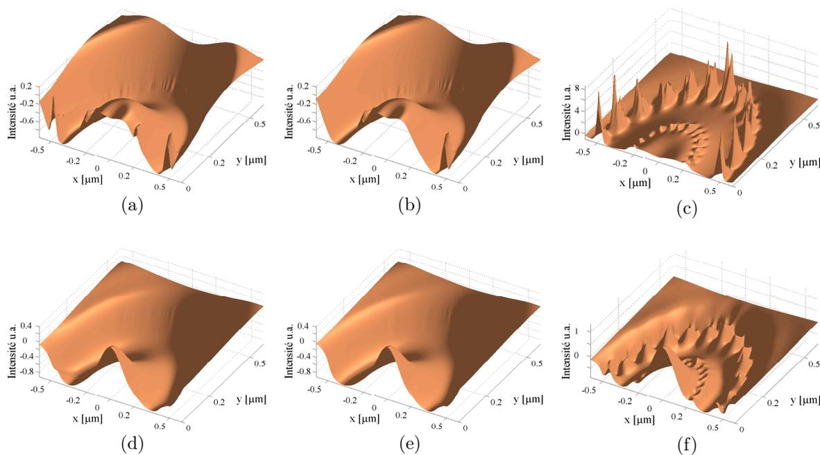
FIG. 3.26 – Variation  $F$  du champ en polarisation azimuthale pour les anneaux segmentés sur les parois internes et externes représentés sur la figure 3.23 respectivement. (a-c) pour le champ électrique, et (d-f) pour le champ magnétique.
