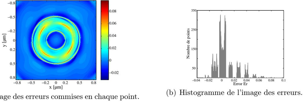
FIG. 3.8 – Résultat de la différence entre le calcul du champ  $E$  réalisé avec  $\Delta z = 5 \text{ nm}$  et  $\Delta z = 7 \text{ nm}$ .
