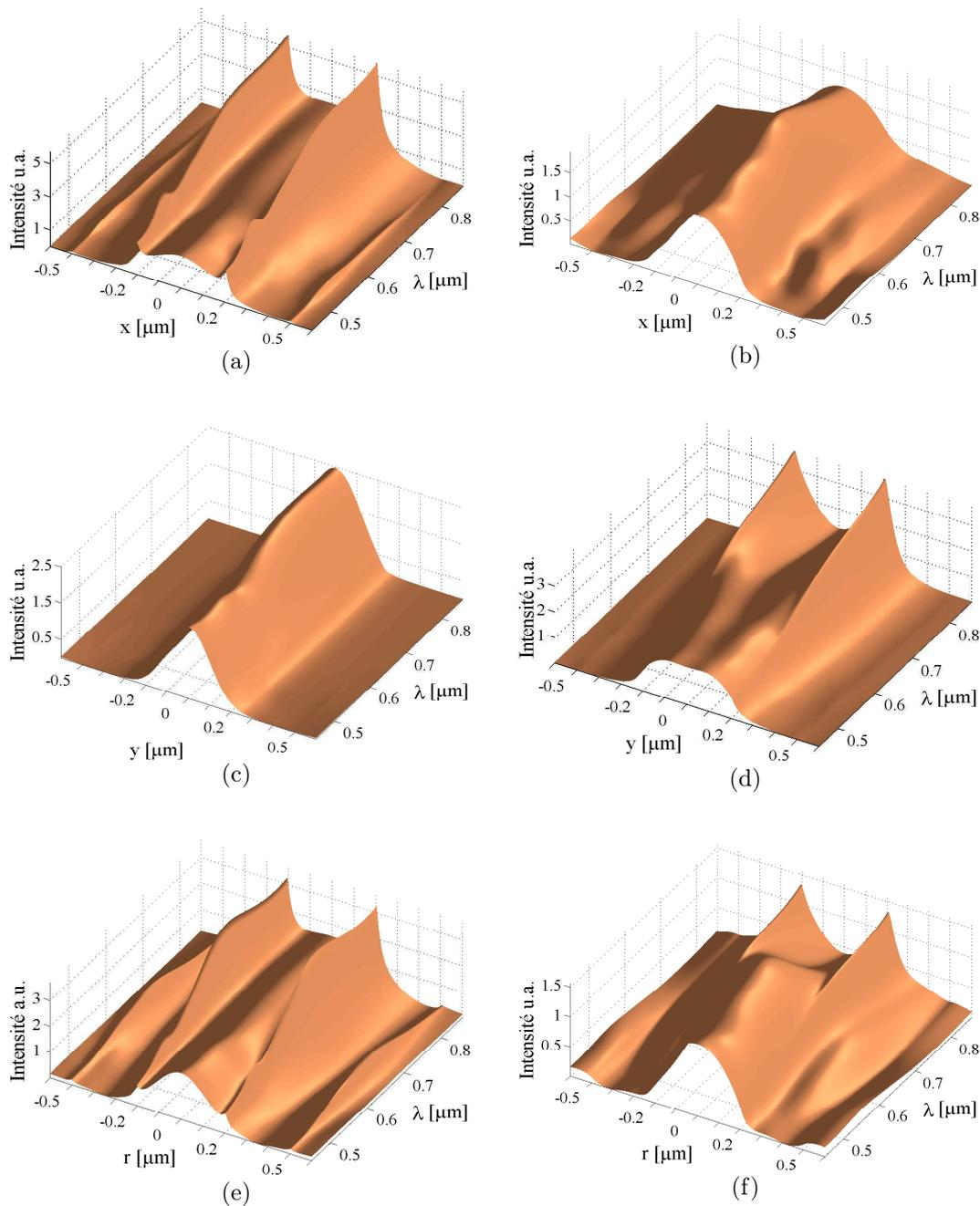
FIG. 3.10 – Spectre normalisé  $S$  pour la polarisation linéaire et circulaire (en  $a-d$  et  $e,f$  respectivement), du champ électrique ( $a,c,e$ ) et du champ magnétique ( $b,d,f$ ). ( $a,b$  et  $e,f$ ) pour la ligne  $y = 0$  (direction de polarisation du champ électrique pour la polarisation linéaire), ( $c,d$ ) pour la ligne  $x = 0$ .
