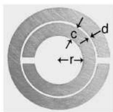
(a) Élément résonnant magnétique *SRR*.
