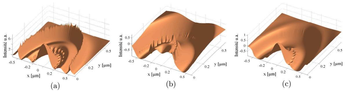
FIG. 3.29 – Variation  $F$  du champ en polarisation radiale (a) et azimutale (b,c) pour l'anneau segmenté sur la paroi interne représenté sur la figure 3.27. (a,b) pour le champ électrique, (c) pour le champ magnétique.
