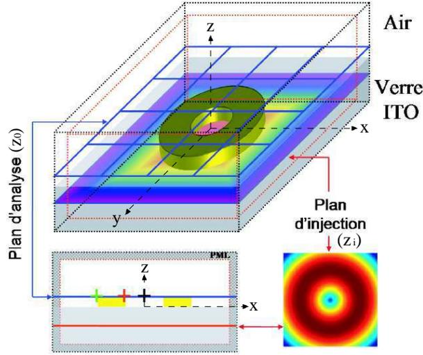
FIG. 3.7 – Représentation de la structure et des conditions de calcul définis pour la simulation.
