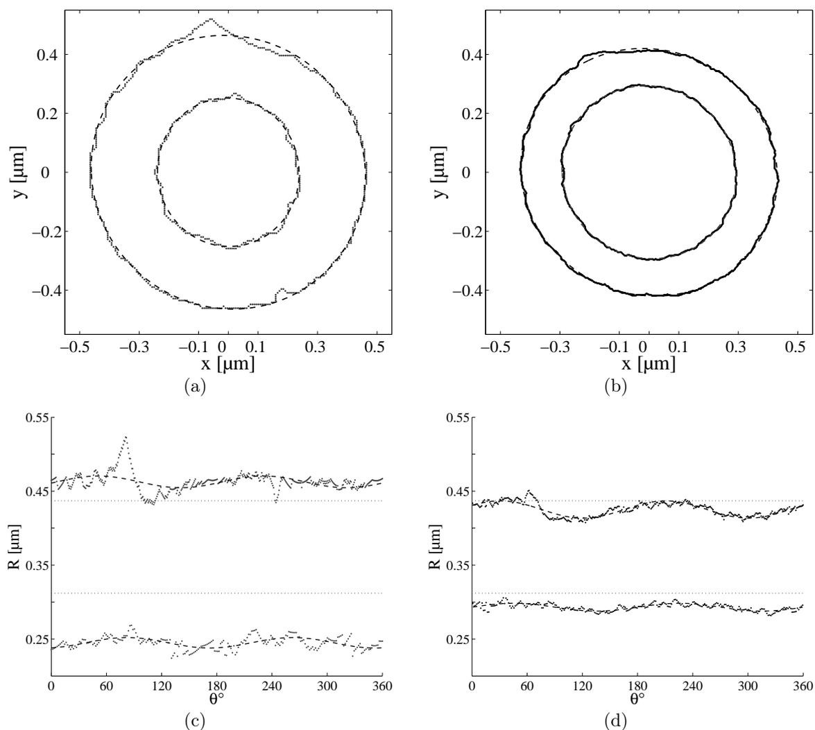
FIG. 4.11 – (a,b) superposition des bords calculés à partir des images *MEB* précédentes ( $r_i$ ) et des ellipses adaptées ( $R_i$ ). (c,d) valeurs de  $r_i$  et  $R_i$  pour chacun des points par échantillonnage angulaire. Pour 1 passage en (a,c) et 4 passages en (b,d).
