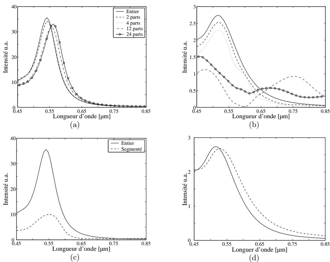
FIG. 3.20 – Courbes spectrales  $S$  au centre de l’anneau dans le plan d’analyse ( $z = z_0 = 7nm$ ). (a,c) pour le champ électrique et (b,d) pour le champ magnétique. (a,b) pour un anneau segmenté radialement en polarisation radiale et azimutale respectivement, (c,d) pour un anneau évidé azimutalement en polarisation radiale et azimutale respectivement.
