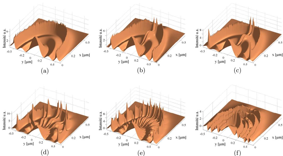
FIG. 3.21 – Variation de l'intensité du champ électrique  $F$  pour la polarisation radiale. (a) pour l'anneau complet, (b-e) quand l'anneau est segmenté radialement, (f) quand l'anneau est évidé azimutalement.
