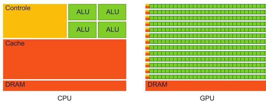
**FIGURE 8.2** – Le GPU alloue plus de transistors (représentés par ALU pour « Arithmetic Logic Unit » sur la figure) au calcul des données que le CPU. Figure inspirée du guide de programmation CUDA de NVIDIA.
