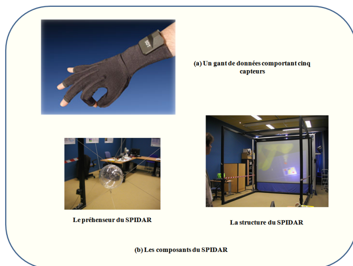
FIG. 6.7 – (a)Gants de données (b) SPIDAR.
