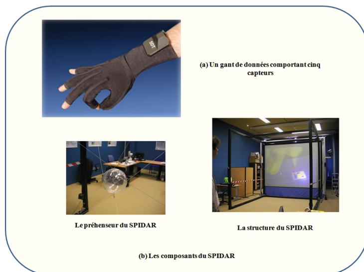
FIG. 6.7 – (a)Gants de données (b) SPIDAR.
