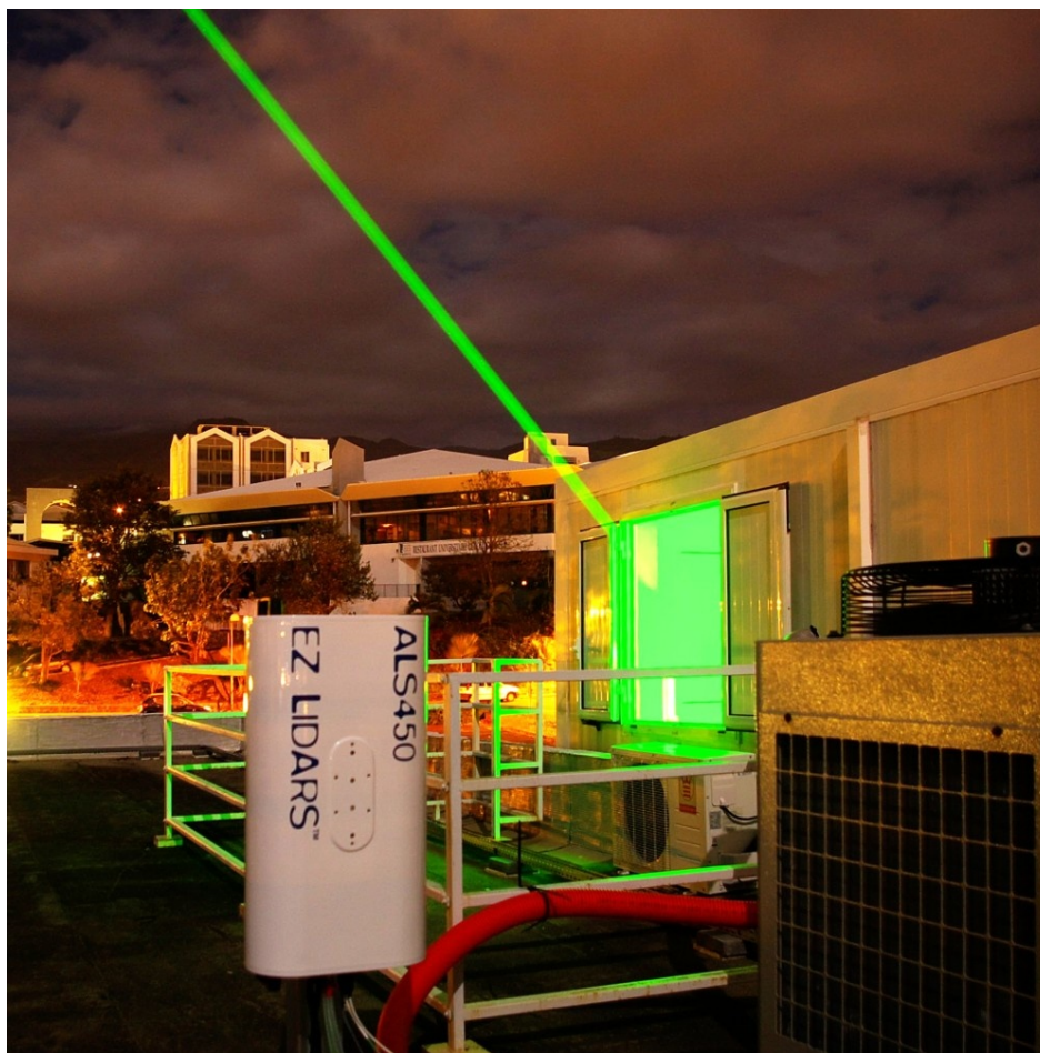
Figure 1.13 Photographie prise le 13 Novembre 2008, montrant en premier plan le lidar leosphere ALS 450, et en second plan, le faisceau incliné à 45 degrés du lidar doppler.
