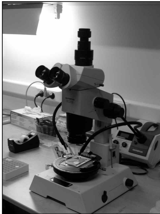
Figure 4.3. Loupe binoculaire utilisée pour effectuer le tri des apatites. La sélection se fait avec des grossissements supérieurs à \times 100 .
