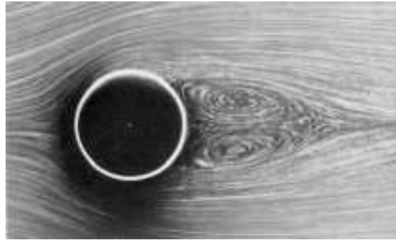
FIG. 2.2 – Écoulement stationnaire décollé à Re = 26 . Visualisation de S. Taneda tirée de van Dyke, [146].
