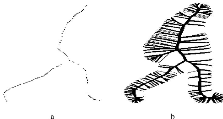
**FIG. 3.11 :** Seuillage de la divergence. Pour un seuil trop faible (a), le squelette obtenu est non-connecté, pour un seuil trop élevé (b), l'épaisseur du squelette est trop importante.
