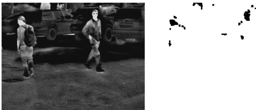
FIG. 4.21 : Zones d'intérêt dans l'image binaire obtenue par seuillage (droite) obtenue à partir d'une image infrarouge (gauche).
