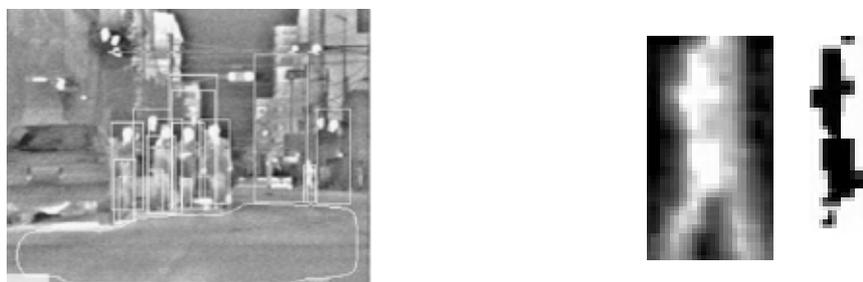
**FIG. 1.5 :** La figure de gauche montre les fenêtres extraites par la méthode de Xu et al. [98] et la zone correspondant à la route. La figure de droite montre une image infrarouge de piéton extraites et sa version binaire.
