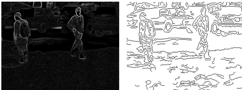
FIG. 4.23 : Image de la norme du gradient (gauche) et contours extraits par la méthode de Sobel (gauche).
