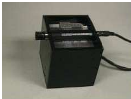
FIG. 1.30 – Capteur hybride : caméra et gyroscope [167].
