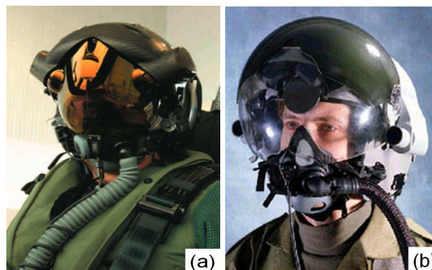
FIG. 1.16 – Les casques utilisés dans les avions de combats. (a) HUD (Head Up Display). (b) HMS (Helmet Mounted Sight).
