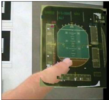
FIG. 3.8 – Gestion d'occultations avec la technique de Fischer et Baratoff [48].
