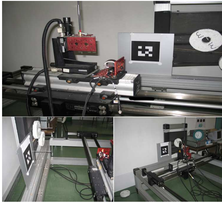
FIG. 2.33 – Banc de calibration utilisé pour l'évaluation de la distance caméra-cible.
