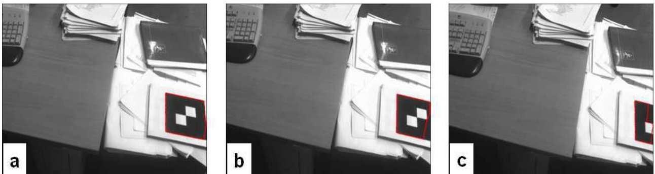
FIG. 2.23 – Détection d'objet subissant une occultation partielle.
