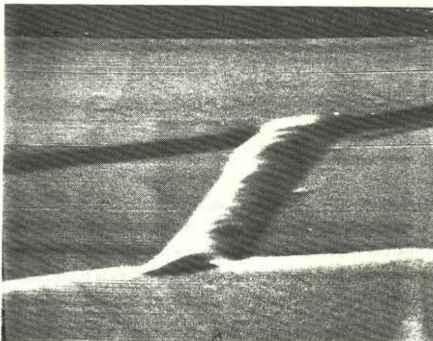
**Photo I-2 :** Micropont reliant deux surfaces d'aluminium réalisé en utilisant le procédé à un niveau de résine. La largeur optimale obtenue est  $0.5 \mu\text{m}$ .
