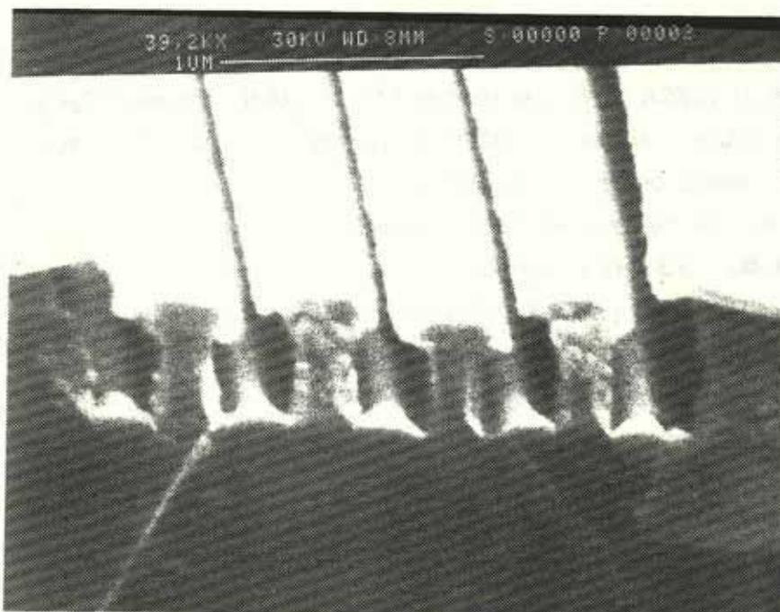
**Photo 1-6 :** Coupe par clivage d'un faisceau de 5 lignes après l'évaporation de Ti-Au et avant l'étape de dissolution de la résine de surplomb ( $\sim 0.1 \mu\text{m}$ ) est à comparer à celui de la photo 1-3.
