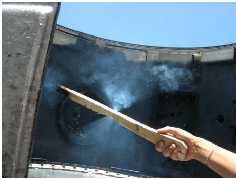
Fig. 1.3: Trajectoire des rayons lumineux au foyer d'un miroir concave visualisé par de la fumée. Cette photo été prise au four solaire de Mont-Louis. On est ici en présence d'un phénomène de diffusion simple : on visualise la propagation rectiligne des rayons lumineux à travers la fumée.
