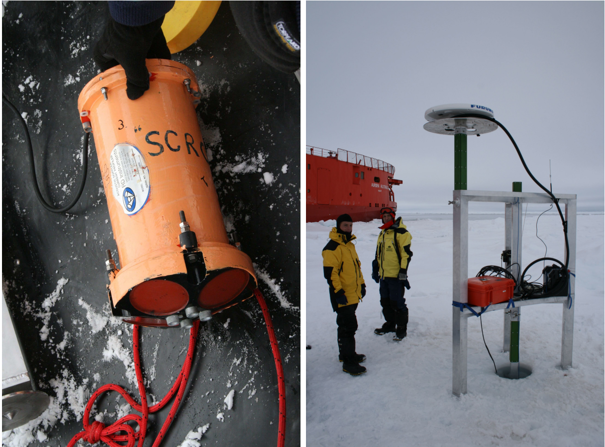
FIG. 1.5: ADCP (gauche) et son armature (droite) utilisés lors de la campagne SIPEX.
