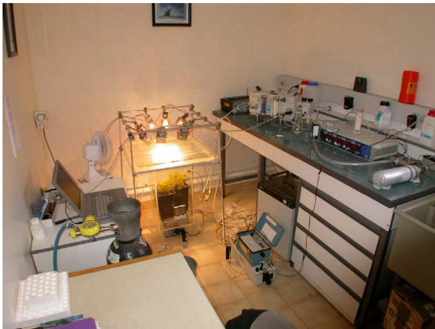
Système de marquage ( ^{13}\text{C} ) mis en place à la Station Alpine Joseph Fourier durant l'été 2005 et 2006. Photo : S. Aubert.
