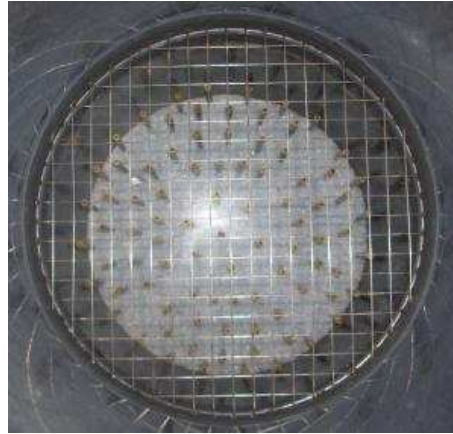
Figure 2-29 Système de tomographie à fils à l'intérieur du réacteur (vue du dessus).
