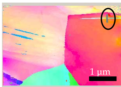
Fig. V.114 : Cartographie des orientations d'un échantillon de la nuance CC3 déformée de 20%.. L'ellipse signale une mesure de désorientation
