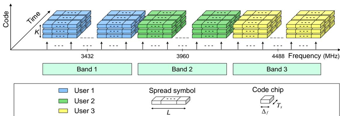
Figure 1 : Représentation schématique de la forme d'onde LP-OFDM.
