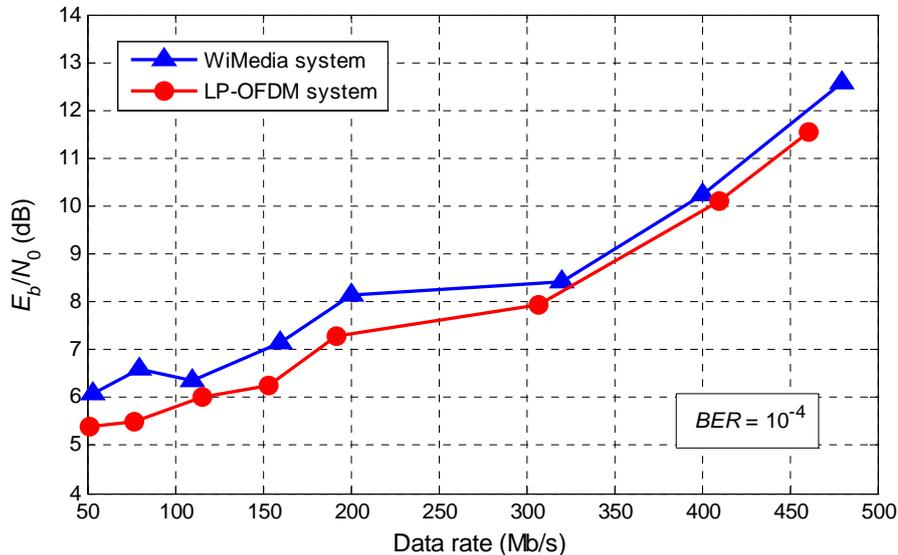
Figure 6 : Performances du système SISO LP-OFDM pour les différents débits proposés : rapport  $E_b / N_0$  nécessaire pour obtenir un taux d'erreur binaire cible de  $10^{-4}$ .
