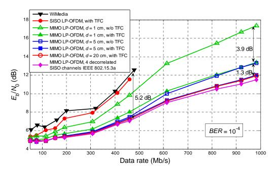
Figure 7 : Performances des systèmes SISO et MIMO LP-OFDM pour les différents débits proposés, à un taux d'erreur binaire cible de 10<sup>-4</sup>.
