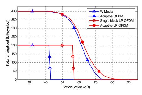
Figure 3 : Débit total des systèmes obtenu en utilisant l'algorithme de maximisation du débit avec des ordres variables de constellation, pour différents niveaux d'atténuation.
