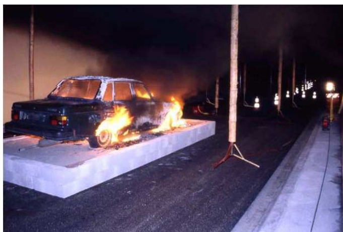
FIG. 1.4 – Campagne d'essais incendie au tunnel de Chamoise en 1995.
