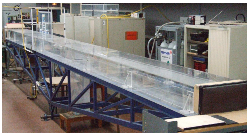
FIG. 1.5 – Vue d'ensemble du canal expérimental en Plexiglas utilisé. Il représente, via une réduction d'échelle au 1 : 20 ème , un tronçon de tunnel routier de 200 m de long et de section droite 10 m × 5 m.
