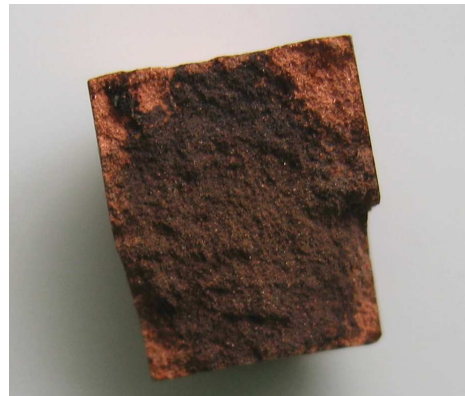
Figure 10 : Coupe d'une pastille de cuivre oxydé compressé à chaud
