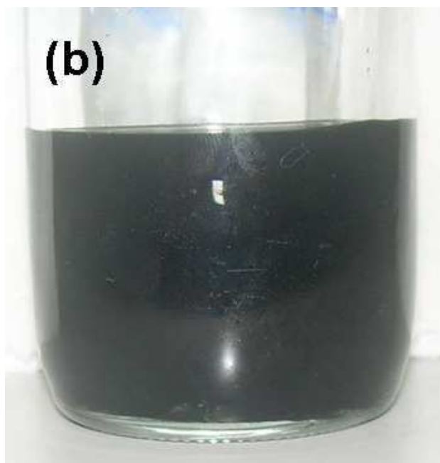
Fig. 5.13: Photographie de la suspension de NTCs bi-feuillets dans la NMP obtenue par le CIRIMAT telle que nous l'avons utilisée au cours des manipulations.
