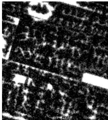
FIG. 3.7: Zoom sur des filaments non retournés de la couche 93L06-ag à l'approche de la saturation. Taille de l'image : 81 \mu\text{m} \times 81 \mu\text{m}
