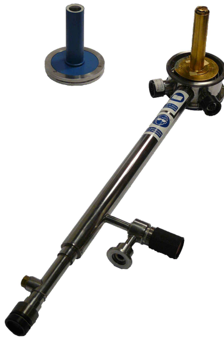
FIG. 2.5: Photographie du cryostat à température variable (modèle HiRes Cryostat II Oxford Instrument). Taille du cryostat : 50 cm \times 15 cm \times 15 cm.
