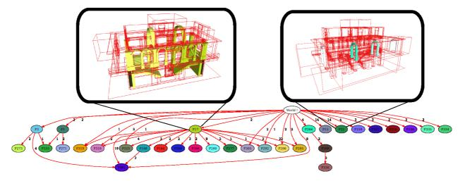
Figure 11: Hiérarchie d'instances optimisée pour le lancer de rayons. Pour cette géométrie, le taux de compression obtenu est d'environ 1:8.
