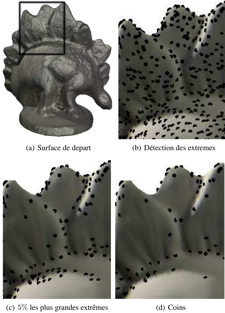
Figure 3.20: Les étapes pour trouver les points d'intérêt. La qualité utilisée est la couleur . Le maillage original a 27240 sommets. Le détecteur des extrémités trouve 5760 points. En mettant en place un seuil qui garde les 5% plus importants parmi les sommets, il reste 1360 sommets. Après considération des coins, il reste 650 sommets.
