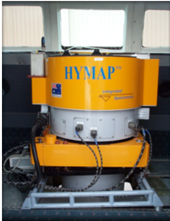
FIG. 7.13 – Imageur hyperspectral HyMap chargé à bord d'un avion (Crédits : HyVista Corp.)
