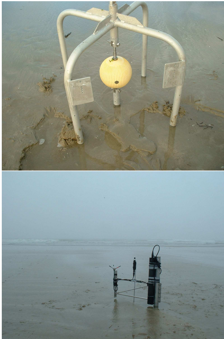
FIG. 3.16 – Courantomètres électromagnétique S4DW (en haut) et acoustique ADV VECTOR muni d'un turbidimètre OBS (en bas).
