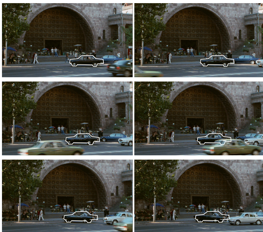
FIGURE 4.12 – Résultat de suivi pour les images I^1 , I^8 , I^{16} , I^{24} , I^{32} , et I^{40} (respectivement de gauche à droite et de haut en bas) de la vidéo Arménie. La méthode utilise un GOP de 14 images. L'erreur de suivi est de 10% de pixels mal classés.
