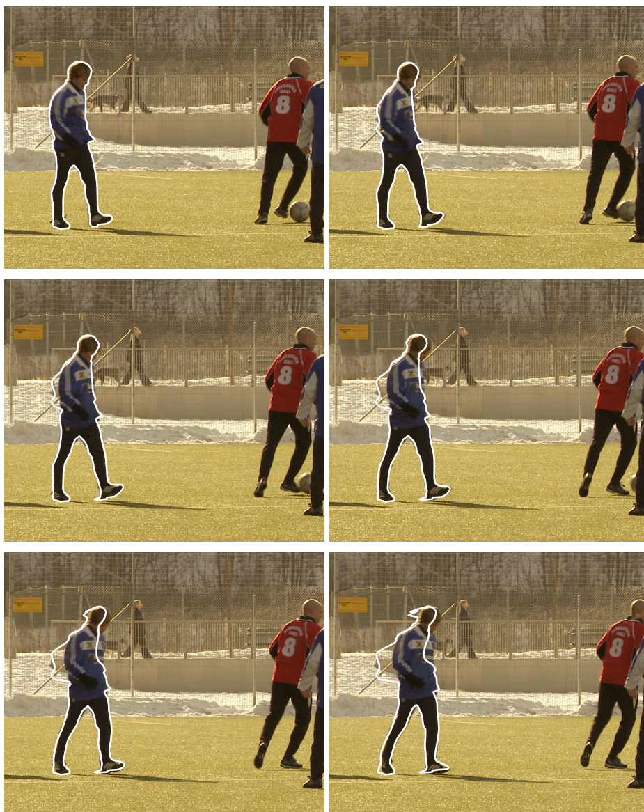
FIGURE 5.15 – Résultat de suivi pour les images I^1 , I^3 , I^5 , I^7 , I^9 , et I^{11} (respectivement de gauche à droite et de haut en bas) de la vidéo Soccer. La méthode utilise le critère de comparaison SAD et un rayon de dilatation de R = 10 . L'erreur est de 17% de pixels mal classés.
