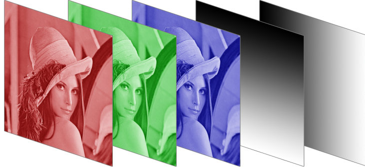
FIGURE 6.3 – Utilisation d'informations couleur et d'informations géométriques pour la description d'une image. Chaque pixel de l'image est défini dans un espace de dimension 5 : 3 composantes couleurs RVB (rouge, vert, bleu) et 2 coordonnées cartésiennes.
