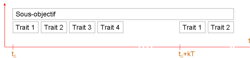
FIG. 6.4 – Composition d'un sous-objectif (ensemble de traitements représentant l'exécution de modules)
