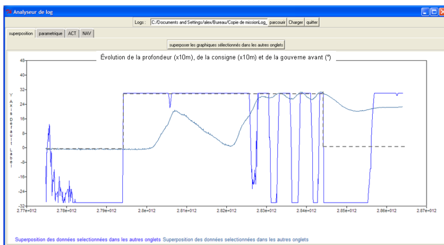
FIGURE 11.4 – Evolution de la profondeur (x10m), de la consigne (x10m) et de la gouverne avant (degrés)
