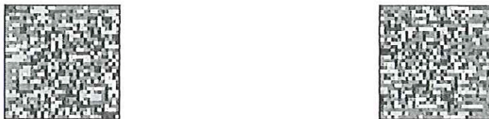
Figure 4.7 : Modélisation du bruit via l'enregistrement d'images d'une scène totalement noire. Les deux images de cette figure illustrent un couple d'images de bruit. Il n'existe a priori aucune corrélation entre ces deux images
