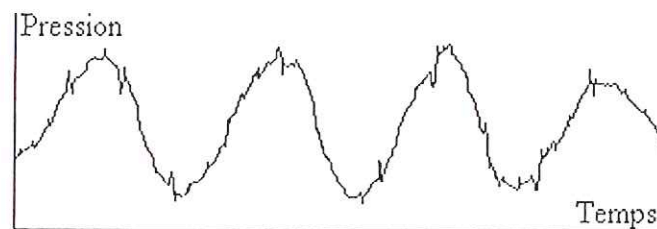
Figure 10.24 : Exemple de signal de pression réalisé sur 4 cycles complets
