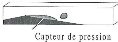
Figure 10.23 : Position du capteur de pression dans la veine venturi.
