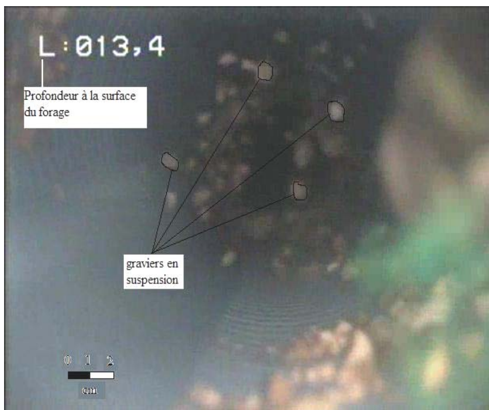
Fig. 5.19- Photographie des graviers en suspension dans un forage.
