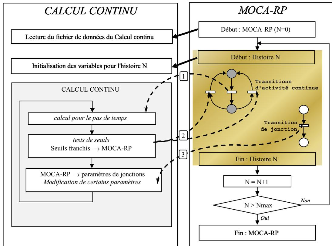
Figure 1.7 – Structure du couplage [Chabot, 1998].
