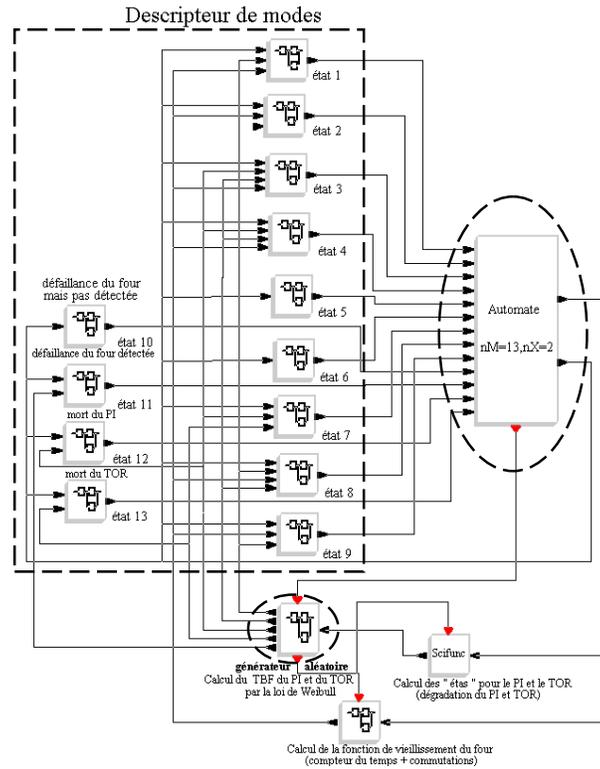
Figure 3.13 – Modèle Scicos du système dynamique hybride.
