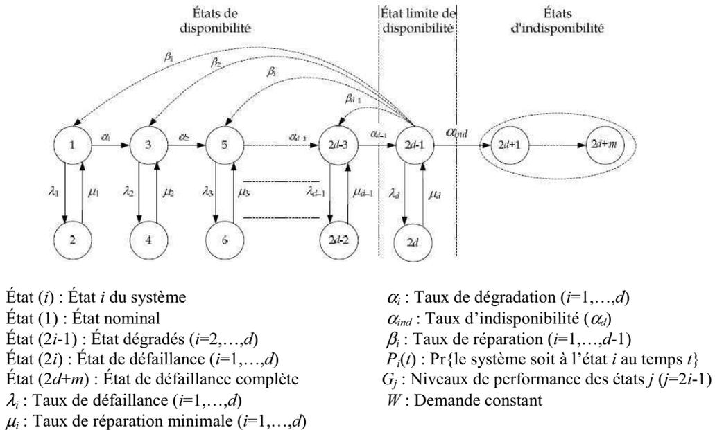
Figure 1.11 – Diagramme de transition d’un SME.
