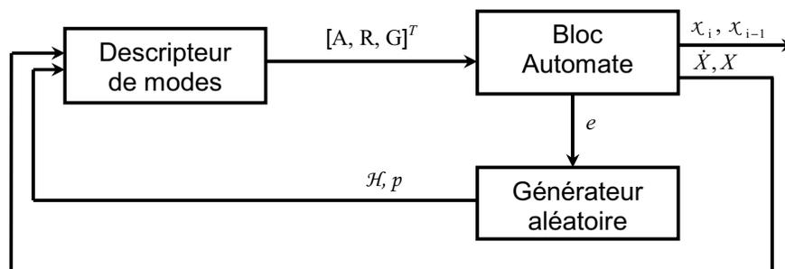
Figure 2.8 – Modèle de l'automate stochastique hybride.
