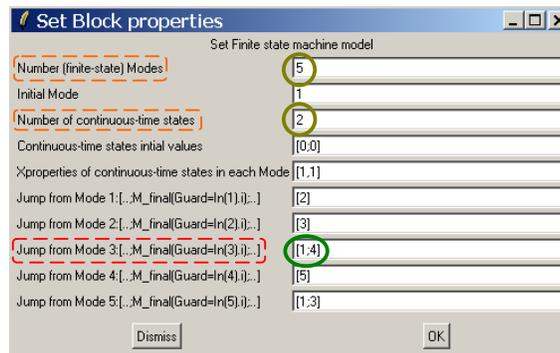
Figure 2.10 – Fenêtre d'interface du bloc automate.
