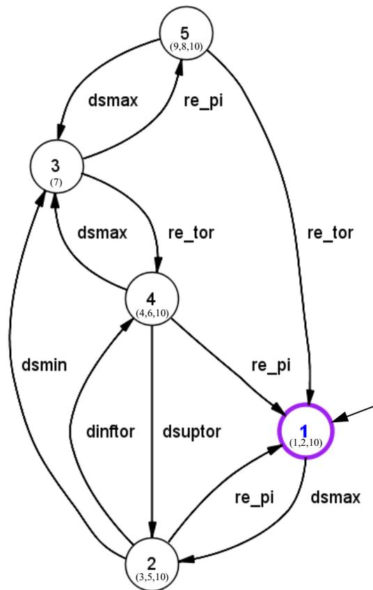
Figure 4.6 – Automate observateur du système.
