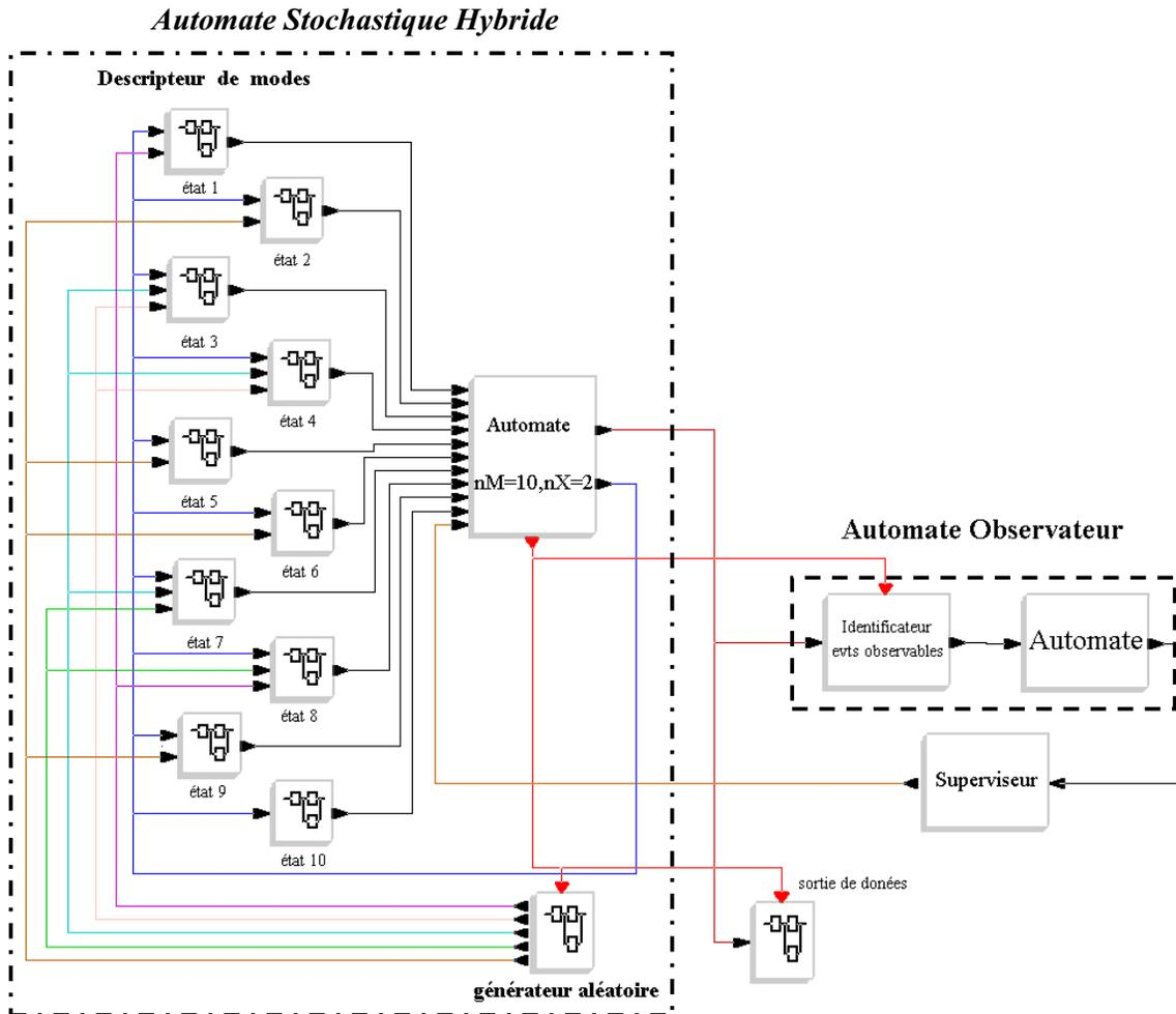
Figure 4.7 – modèle Scicos du système contrôlé par supervision.
