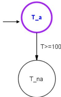
Figure 3.25 – Automate à état fini de la température.
