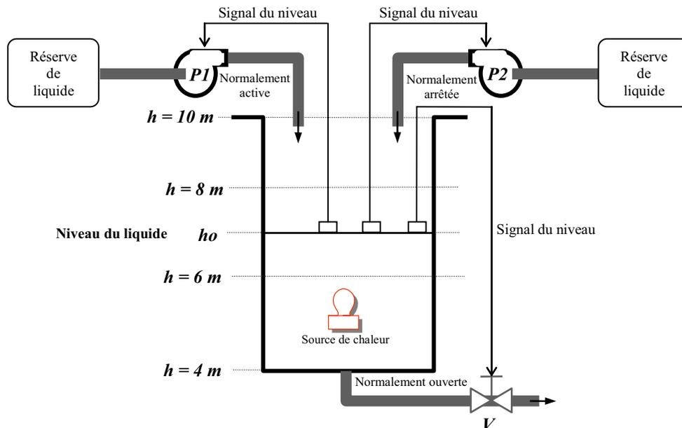
Figure 3.18 – Réservoir et sa régulation de niveau.
