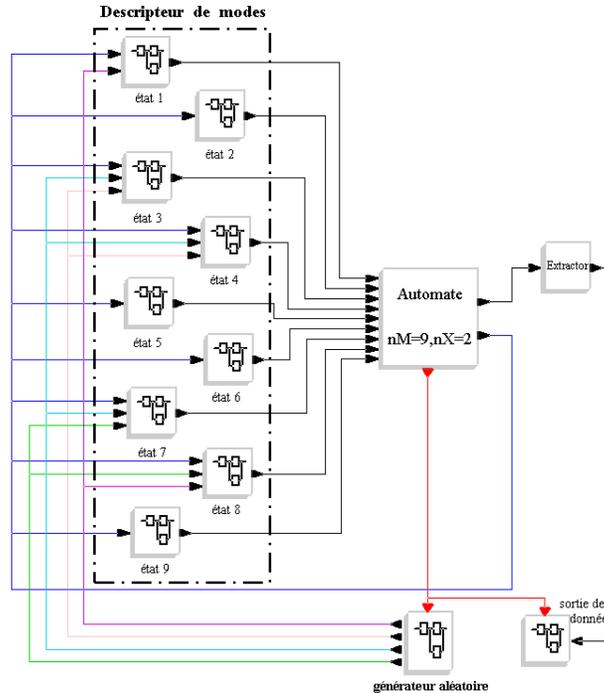
Figure 3.2 – Modèle Scicos du système hybride (cas test).
