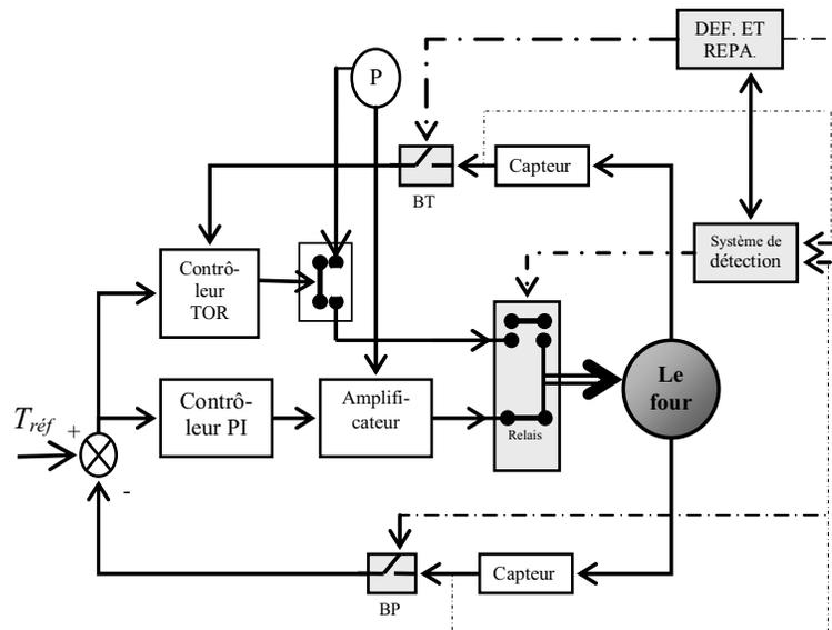
Figure 2.4 – Diagramme structurel du système de contrôle de la température d'un four.
