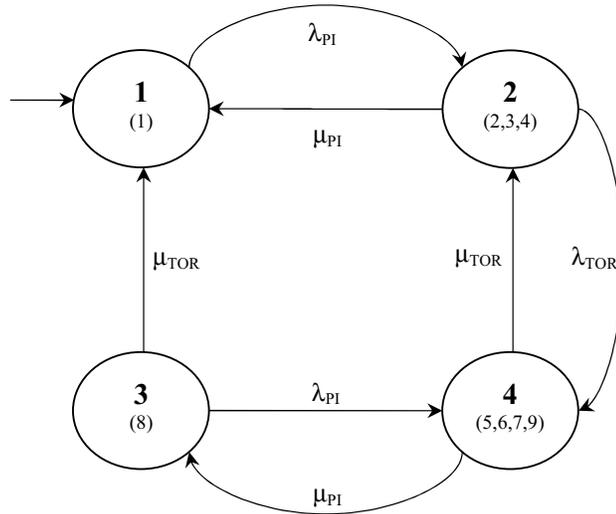
Figure 3.8 – Graphe de Markov équivalente à la matrice de transition  $A$ .
