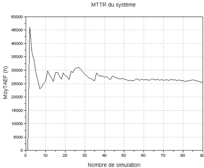
Figure 3.17 – Temps moyen d'accès à l'état de fonctionnement.
